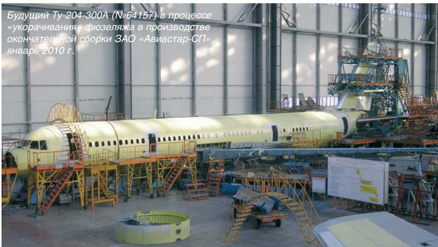
Будущий Ту-204-300А (№64157) в процессе «укорачивания» фюзеляжа в производстве окончательной сборки ЗАО «Авиастар-СП», январь 2010 г.
