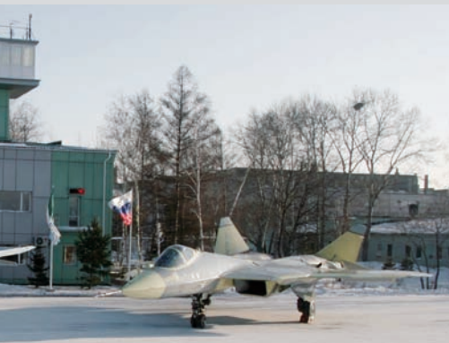
Параллельные плоскости и кромки – признак применения технологий малозаметности в конструкции ПАК ФА
