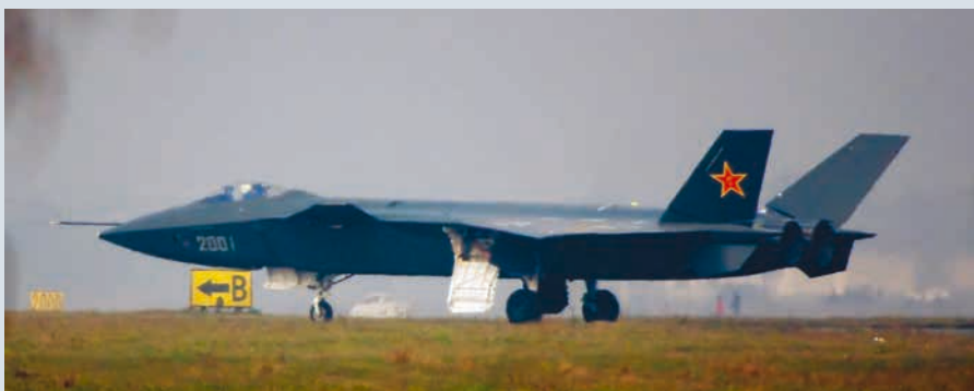
Первые фотографии J-20, появившиеся в китайском интернете в конце декабря 2010 г. Если судить по конфигурации реактивных сопел, можно предположить, что на этом этапе самолет оснащался российскими двигателями AL-31ФН
