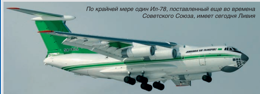
Один из более чем десятка танкеров Ил-78, превращенных в постсоветские годы на Украине в обычные транспортные самолеты и переданных в эксплуатацию в коммерческие авиакомпании
