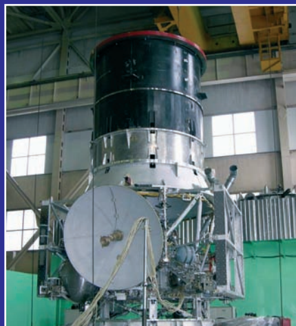
Спутник «Спектр-Р» на виброиспытаниях в НПО им.С.А. Лавочкина
