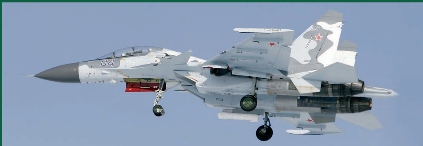
Один из двух прототипов Су-30МКМ в испытательном полете с контейнером «Домоклес»
