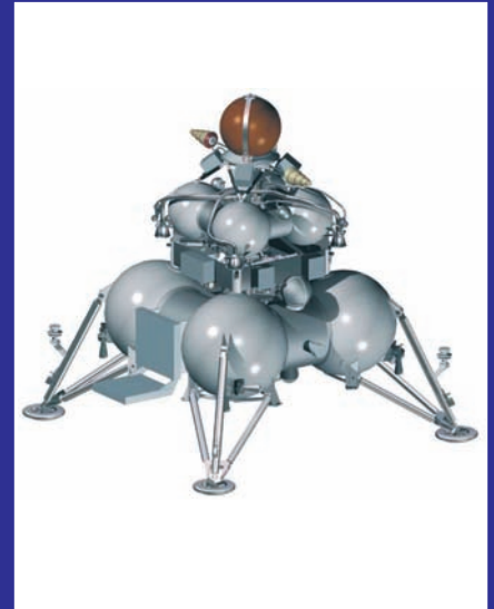
КА проекта «Луна-Грунт» в посадочной конфигурации
