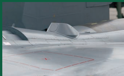
Блок датчиков обнаружения атакующих ракет на гаргроте
