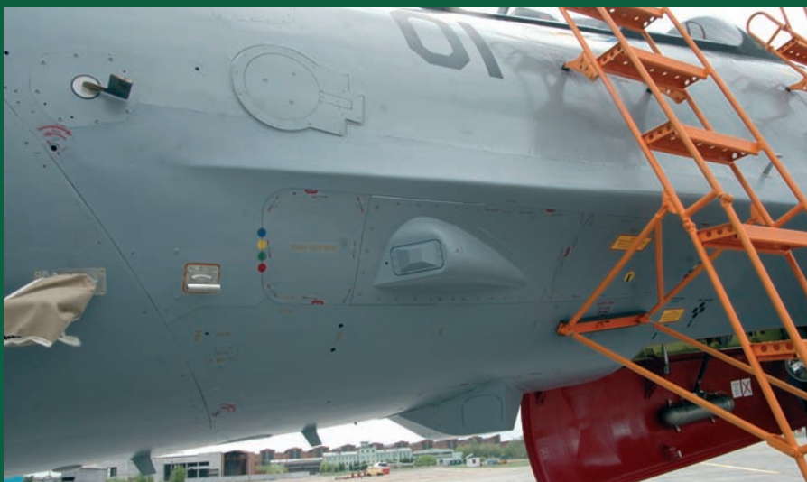
Датчики комплекса обороны на нижней поверхности головной части фюзеляжа
