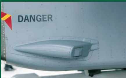
Датчик обнаружения лазерного облучения на воздухозаборнике
