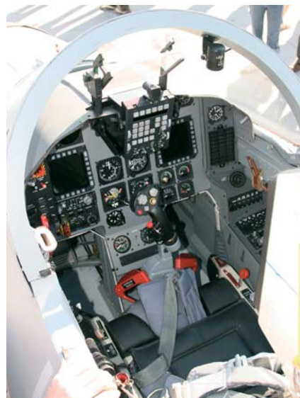
Вверху: по сравнению с МиГ-21МФ, в кабине «Грипена» меньше стрелочных приборов, зато есть жидкокристаллические индикаторы Слева: подготовка чешских «Грипенов» к полетам на авиабазе «Часлав».
