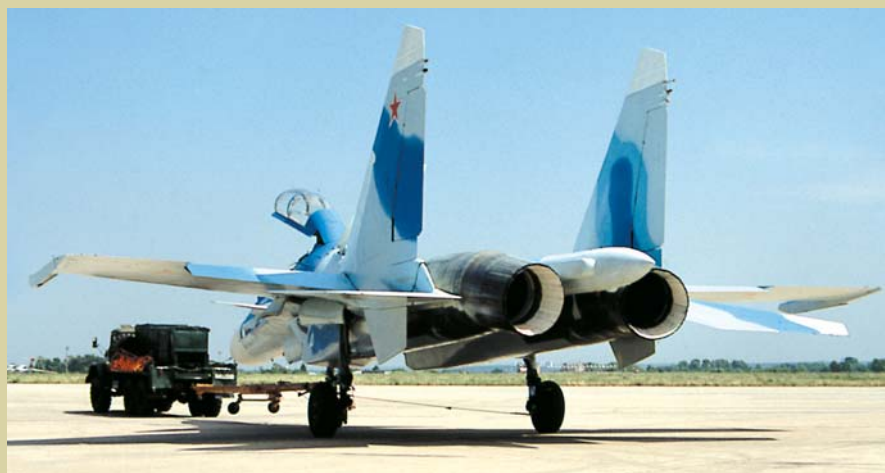
Второй прототип Су-30МКИ с двигателями АЛ-31ФП, 1998 г. По сравнению с Су-37, изменение положения оси поворота сопел позволяет получить не только вертикальную, но и боковую составляющую тяги.
