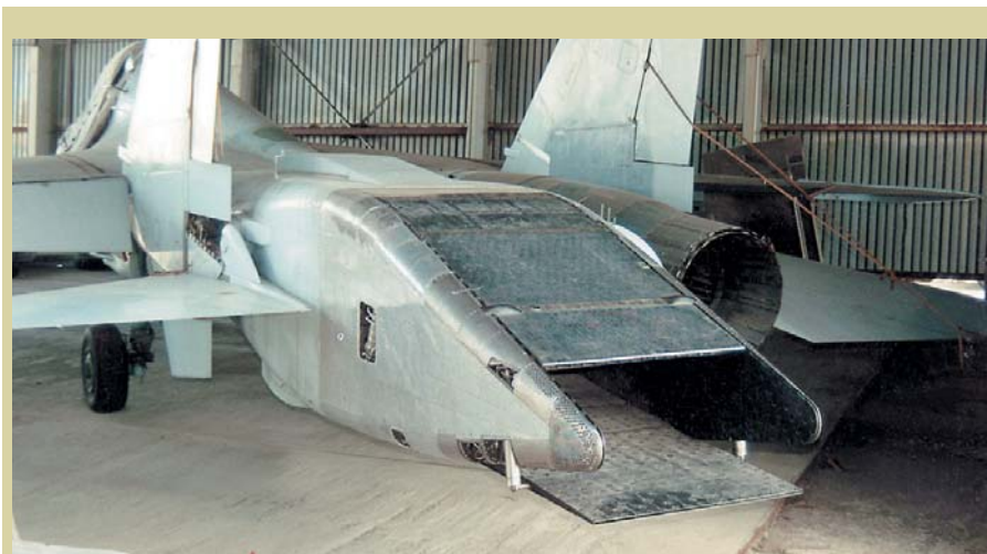
Вверху: опытное плоское сопло с УВТ в вертикальной плоскости и реверсом тяги на двигателе АЛ-31Ф летающей лаборатории Су-27УБ №02-02 – ЛЛ-УВ(ПС), 1990 г.
