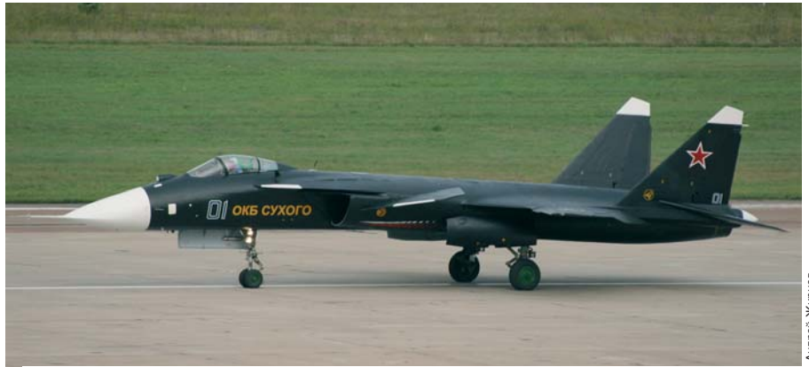
Экспериментальный самолет с крылом обратной стреловидности Су-47 «Беркут» в настоящее время используется как летающая лаборатория для отработки систем и отдельных технических решений по программе создания истребителя пятого поколения
