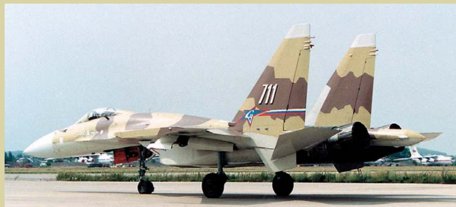
Опытный истребитель Т10М-11 (Су-37) с опытными двигателями АЛ-31Ф с УВТ, 1996 г.
