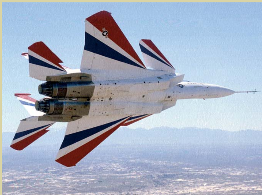
Летающая лаборатория F-15 ACTIVE. В 1988–1991 гг. самолет летал по программе F-15 S/MTD и имел плоские сопла с УВТ по тангажу и реверсом тяги. В 1995 г. получил двигатели F100-PW-229 с осесимметричными соплами P/YBBN с всеракурсным УВТ
