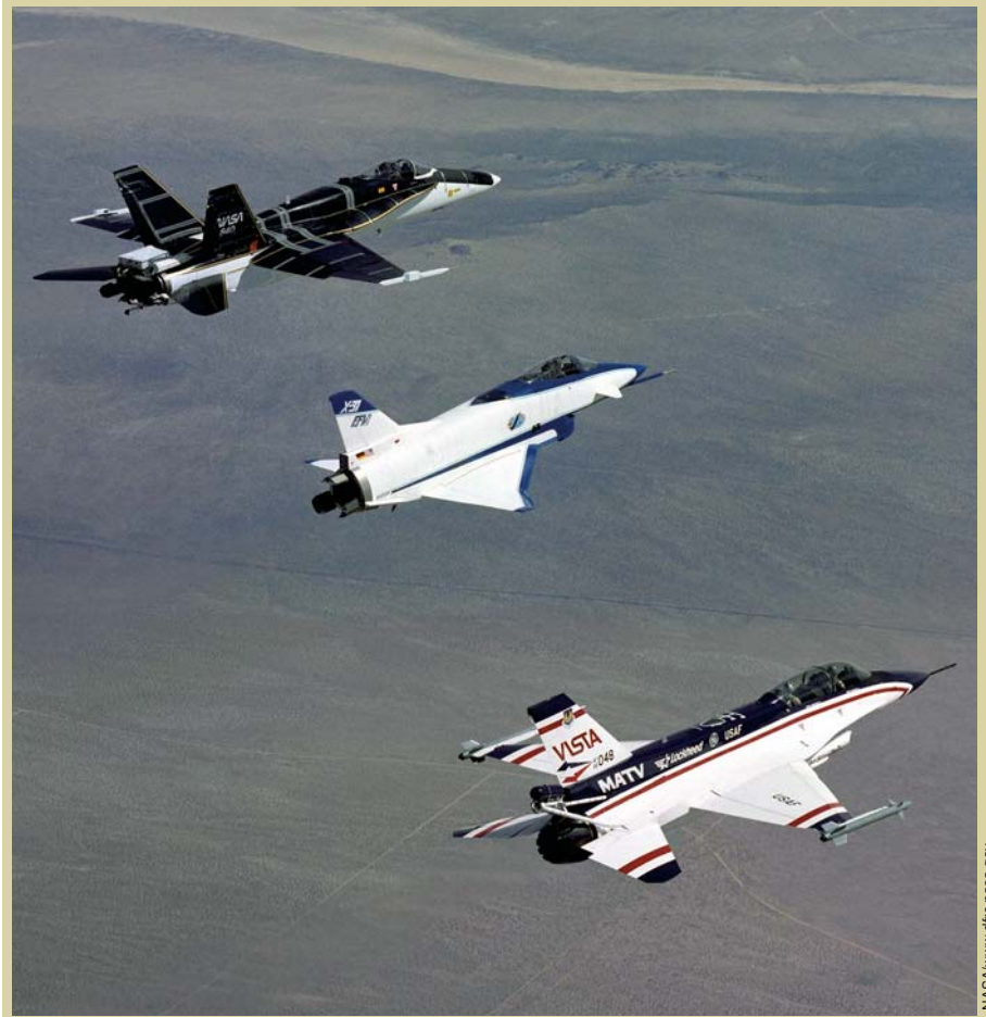
В полете – три летающие лаборатории NASA для отработки управления вектором тяги на самолетах-истребителях. Сверху вниз: F-18 HARV, X-31, F-16 MATV. Первые два для отклонения вектора тяги имеют специальные створки-дефлекторы позади основного сопла двигателя, последний оснащается осесимметричным соплом AVEN с всеракурсным УВТ за счет поворота створок сверхзвуковой части
