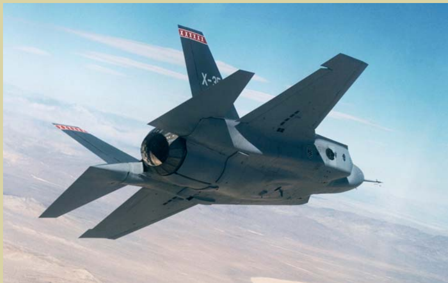
Прототип перспективного «единого» истребителя F-35A, опытный самолет X-35A, так же, как и будущие серийные машины, оснащен одним двигателем F135 с осесимметричным соплом, имеющим систему всеракурсного УВТ
