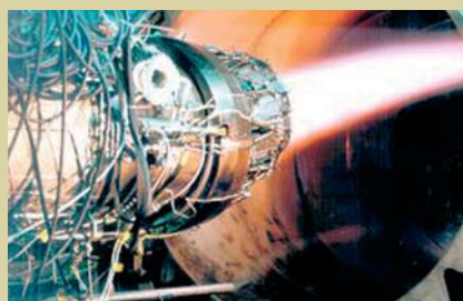
Демонстрация отклонения вектора тяги соплом TVN, разработанным в 1998 г. испанской фирмой ITP для двигателя EJ200 истребителя EF2000 «Тайфун»
