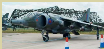
Первый в мире серийный СВВП «Харриер» (1966 г.), подъемно-маршевый двигатель которого оснащен четырьмя поворотными соплами
