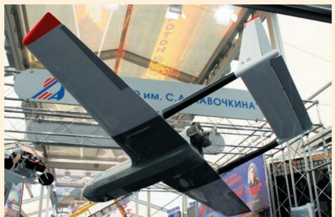
способен находиться в воздухе до 6 ч и контролировать периметр до 300 км (при использовании ретранслятора – до 500 км). Как сообще-
