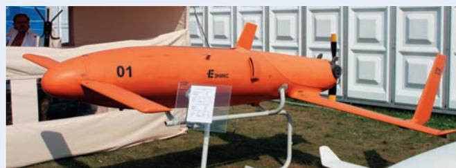
«Астра» и Е22 «Берта» (стартовая масса соответственно 130 и 150 кг). Последние два аппарата являются воздушными мишенями, предназначенными для тренировок расчетов систем ПВО, причем «Астра» (на фото слева) представляет собой БЛА воздушного старта (запускается с самолета-носителя), а «Берта» (на фото сверху) – наземного. Посадка аппаратов –
