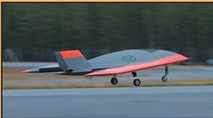
Экспериментальный малоразмерный реактивный БЛА «Филур» (FILUR), разработанный шведской компанией SAAB по контракту Минобороны Швеции стоимостью 9,75 млн долл., предназначался для отработки технологий снижения радиолокационной и тепловой заметности перспективных боевых беспилотников. Первый полет «Филура» состоялся 10 октября 2005 г., программу испытательных полетов планировалось завершить к концу 2006 г.
