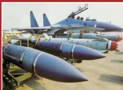
Су-30МКК стали в 2000 г. первыми многоцелевыми истребителями «Сухого» в ВВС НОАК (вверху и вверху справа), способными применять широкую номенклатуру управляемого вооружения класса «воздух–поверхность», включающую, в т.ч., ракеты Х-31П, Х-59МЭ и корректируемые бомбы КАБ-1500Кр (слева) В 2004 г. истребители «Сухого» пришли и в морскую авиацию НОАК. Ими стали модифицированные Су-30МКК с расширенными боевыми возможностями в режиме «воздух–поверхность» (справа)
