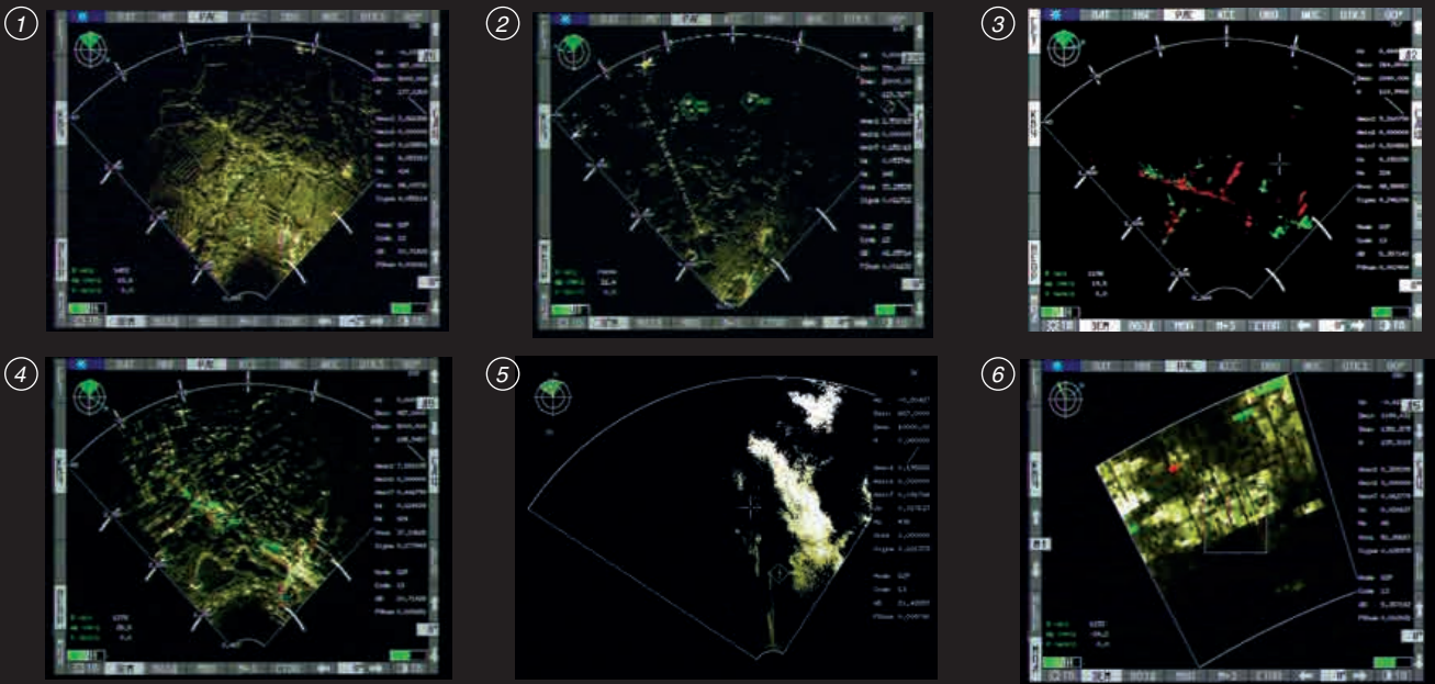
Вид многофункционального индикатора в различных режимах работы РЛС (снимки получены с системы видеорегистрации вертолета): 1 – картографирование земной поверхности (режим ОЗП); 2 – режим обнаружения опор ЛЭП, сопровождение трех целей и захват 4-й (зеленый ромб); 3 – режим СДЦ при обзоре земной поверхности, обнаружение только подвижных наземных целей (зеленый цвет – удаляющиеся цели, красный – приближающиеся цели); 4 – режим ОЗП + СДЦ, обнаружение подвижных (красный и зеленый цвет) и неподвижных наземных целей; 5 – обнаружение метеобразований (с подвижного стенда на базе автомобиля «Газель»); 6 – режим «Микроплан»
