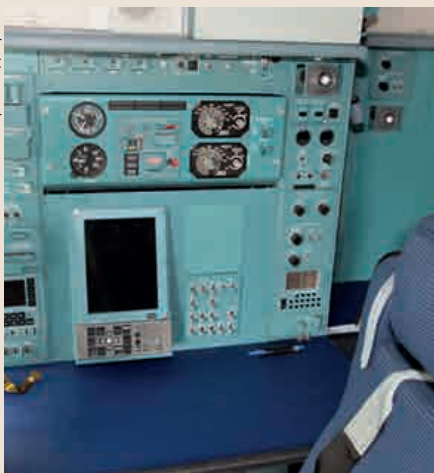
Цветные многофункциональные ЖКИ появились и на рабочих местах штурмана и бортинженера
