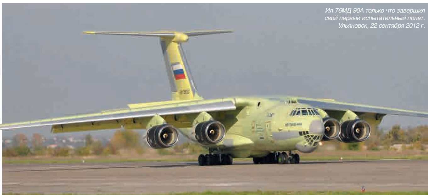
Консоли крыла Ил-76МД-90А получили новую двухлонжеронную конструктивно-силовую схему и стали неразъемными по размаху, выполненными с использованием длиномерных панелей с приклепанными к ним стрингерами. Ульяновск, август 2012 г.
