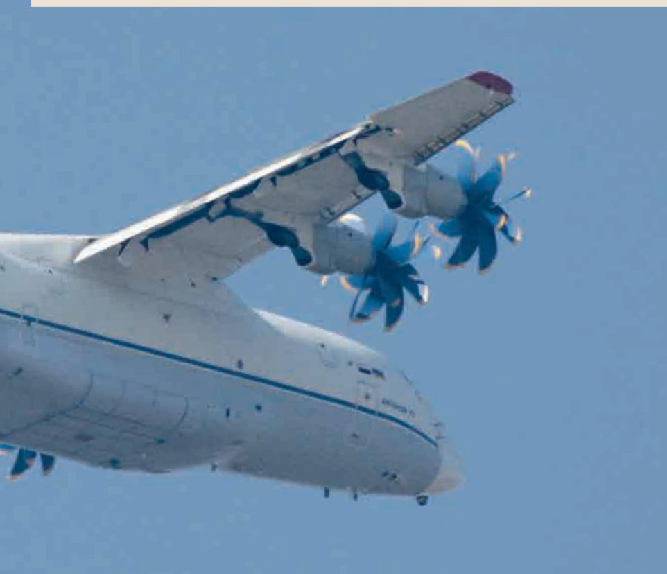
Под носовой частью фюзеляжа появилась пилотажная оптико-электронная система
