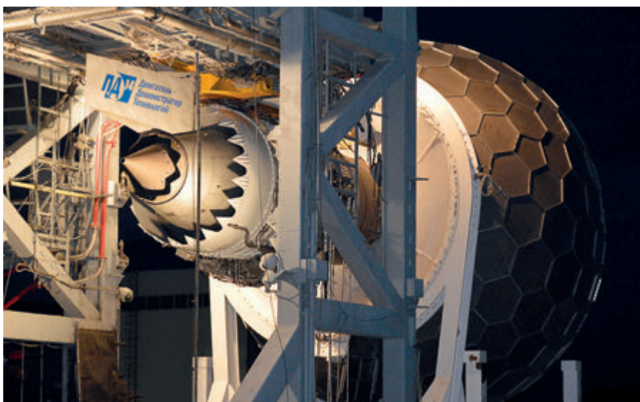
Испытания двигателя-демонстратора на открытом испытательном стенде, в ходе которых оценивались акустические характеристики будущего ПД-14
