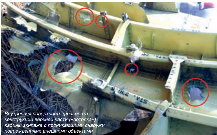
Пол кабины экипажа с отверстиями, пробитыми сверху вниз (обведены красным)
