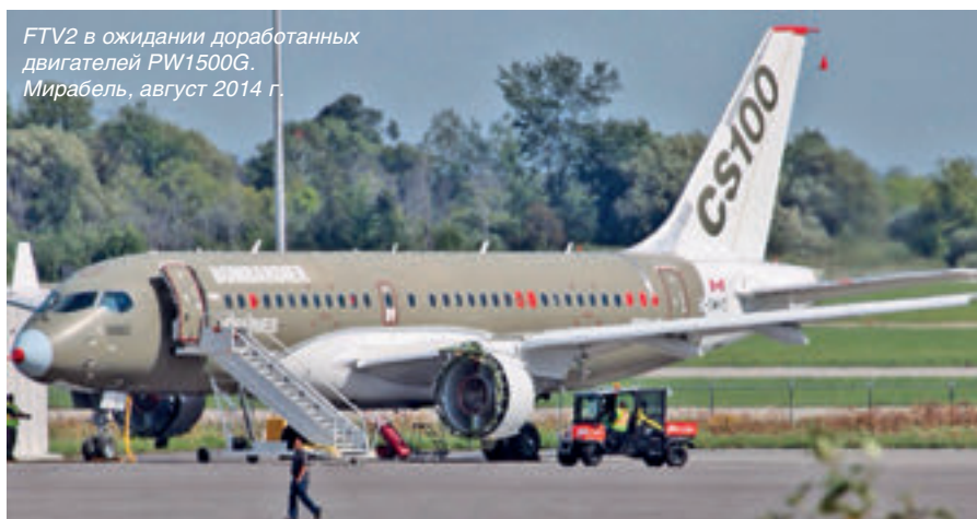
Наземные испытания доработанных PW1500G на борту второго опытного CS100. Мирабель, 5 сентября 2014 г.
