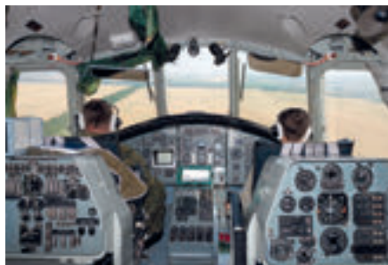
Кабина Ми-26Т (слева) и Ми-26Т2 (справа): вместо четырех членов экипажа – два, вместо стрелочных приборов – многофункциональные индикаторы
