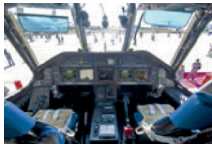
Кабина Ми-26Т (слева) и Ми-26Т2 (справа): вместо четырех членов экипажа – два, вместо стрелочных приборов – многофункциональные индикаторы
