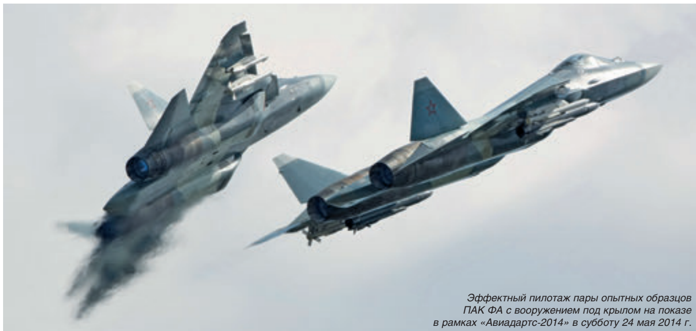
Один из двух Т-50, участвовавших в показе «Авиамикс», несущий под крылом две ракеты «воздух-воздух» средней дальности и две скоростные управляемые ракеты «воздух-поверхность»
