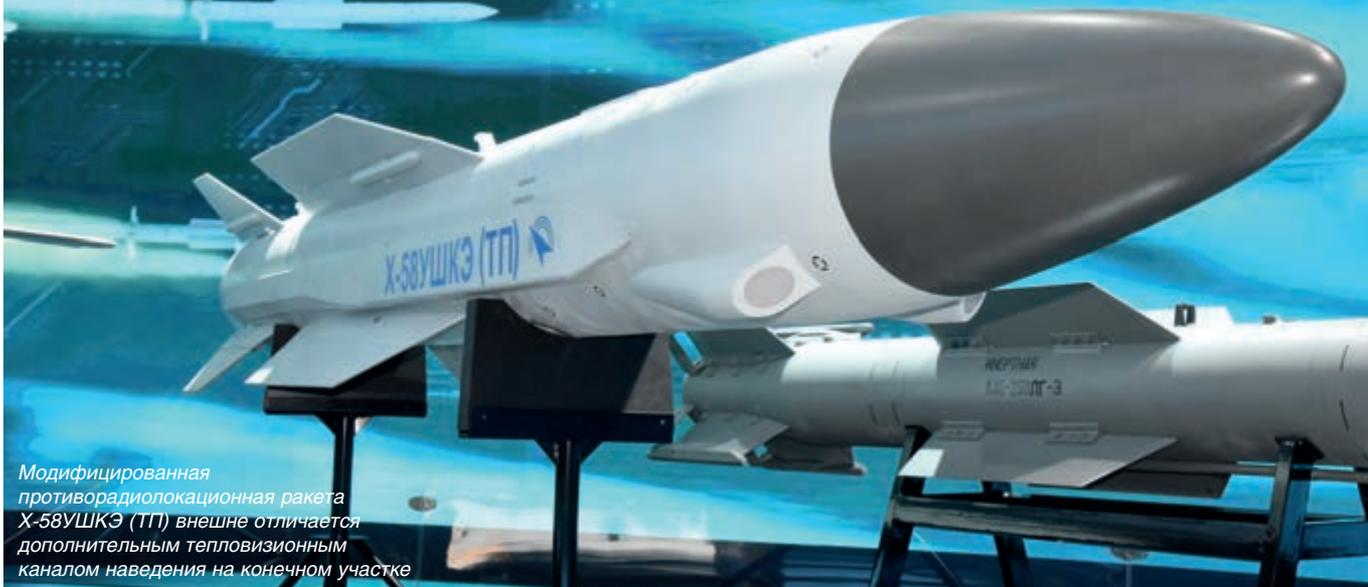
Модифицированная противорадиолокационная ракета X-58УШКЭ (ТП) внешне отличается дополнительным тепловизионным каналом наведения на конечном участке
