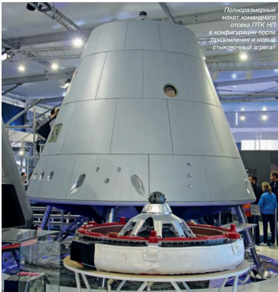
Полноразмерный макет командного отсека ПТК НП в конфигурации после приземления и новый стыковочный агрегат
