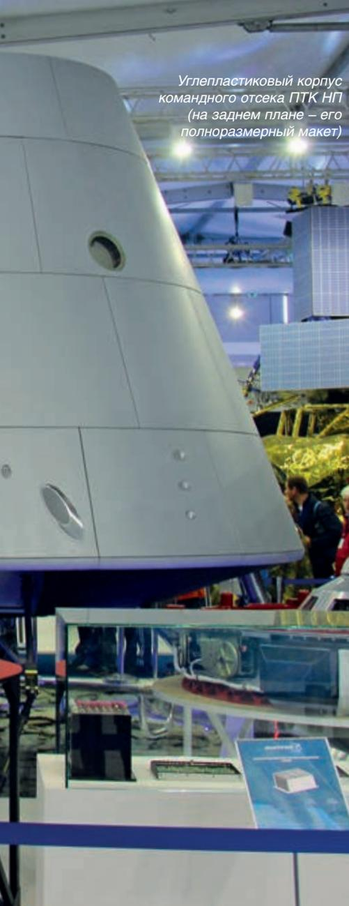
Углепластиковый корпус командного отсека ПТК НП (на заднем плане – его полноразмерный макет)
