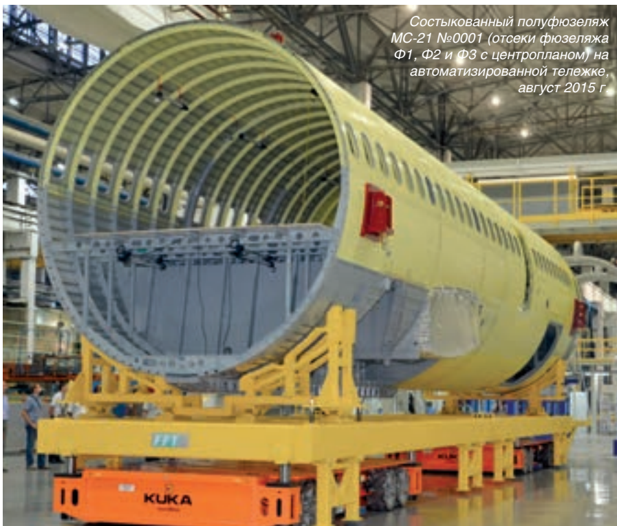
Оператор управляет автоматизированной тележкой для перемещения панелей и отсеков фюзеляжа по линии сборки
