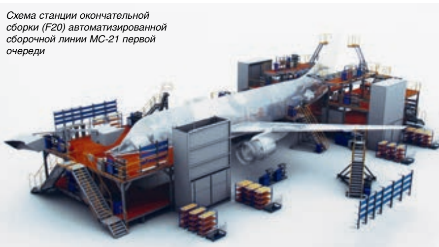
Схема размещения первой очереди автоматизированной линии агрегатной и окончательной сборки самолета МС-21 в цехах Иркутского авиазавода
