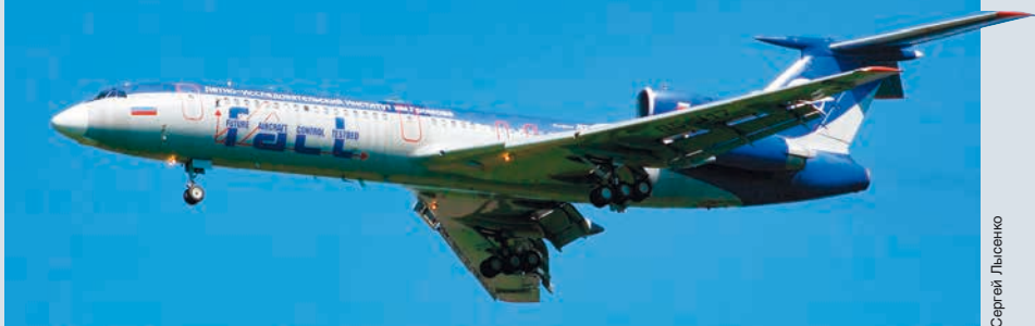
Летающая лаборатория Ту-154ЛЛ №85317 для отработки перспективных систем управления. В ЛИИ в шутку именуется «ни Бэ ни Мэ», т.к. создана в 1987 г. на базе серийного Ту-154Б, доработанного к тому времени по типу Ту-154М, но сохранившего при этом некоторые конструктивные особенности базовой модификации
