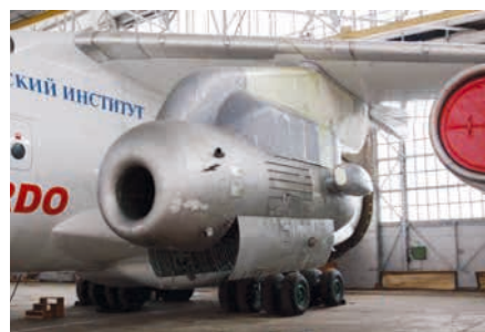
Летающая лаборатория Ил-76ЛЛ №76456, созданная в ЛИИ в 2004 г. на базе пятого СКИП «976» по заказу КНР. С 2005 г. используется для испытаний авиационных двигателей в Китае
