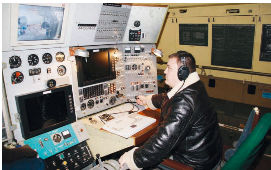
Летающая лаборатория Ил-76ЛЛ №76456, созданная в ЛИИ в 2004 г. на базе пятого СКИП «976» по заказу КНР. С 2005 г. используется для испытаний авиационных двигателей в Китае
