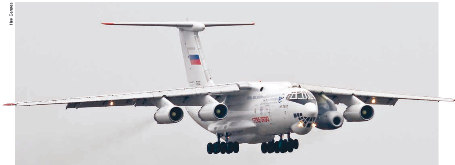
Летающая лаборатория Ил-76ЛЛ №76492, на которой с ноября 2010 г. в ЛИИ проходит испытания индийский реактивный двигатель «Кавери». К марту этого года выполнены первые 4 из 43 запланированных полетов
